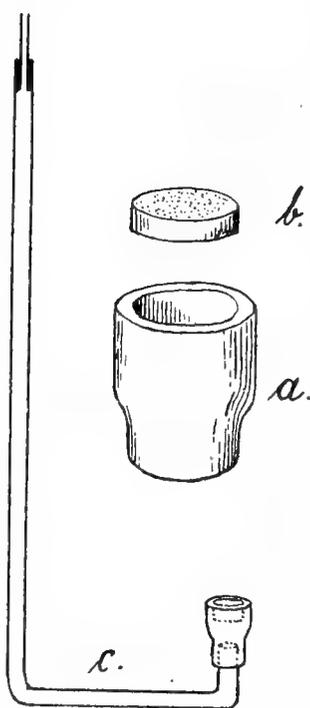
Ausströmer für Durchlüftungsanlagen.
